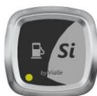
Желтый светодиод в левом нижнем углу включен. Двигатель работает на бензине.
