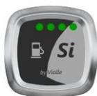
Правый, 4 верхних зеленых, светодиода и правый нижний красный светодиод указывают количество сжиженного газа в баке. Если все 4 зеленых светодиода включены, бак заполнен до максимальной емкости. Максимальная емкость составляет около 80% от общего объема.
