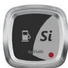
Верхние зеленые светодиоды выключены, кнопка подает два звуковых сигнала, а правый нижний красный светодиод горит. Двигатель все еще работает на газу, но пришло время для дозаправки.
