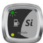
Желтый светодиод в левом нижнем углу включен. Верхний левый зеленый светодиод мигает, чтобы указать, что выбран газ. Двигатель все еще работает на бензине, и система готовится перейти на газ. Когда двигатель работает на газу, верхние зеленые светодиоды включены.
